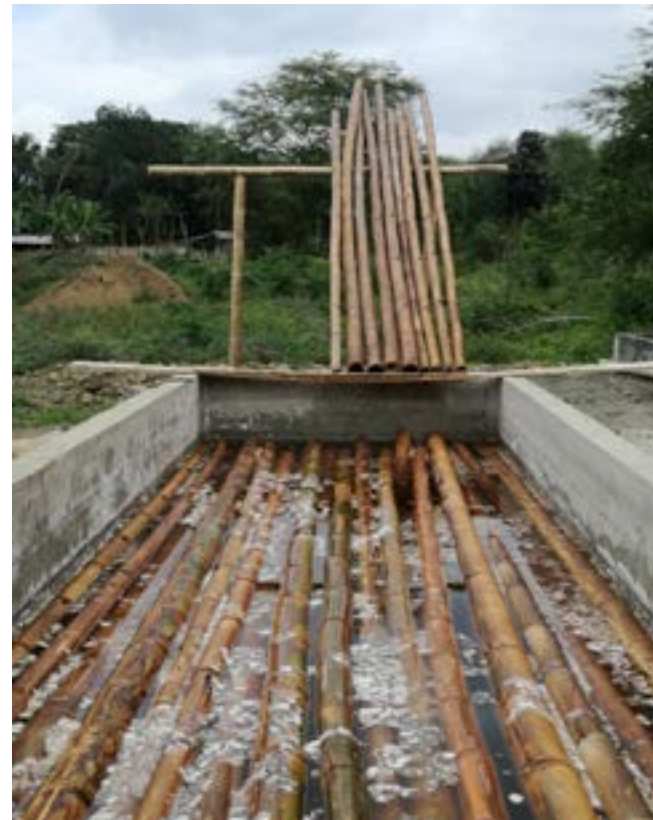
Fig.1 Trattamento dei culmi con acido borico e borace
