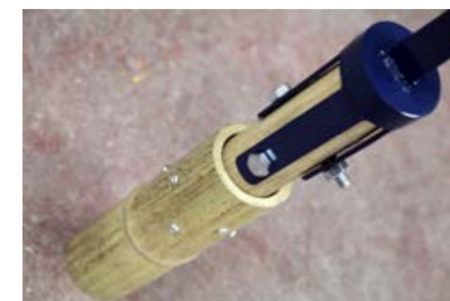
Fig.3 Prototipo di connessione realizzato con legno, viti autofilettanti e perni in acciaio adatto alle strutture reticolari piane e spaziali (M. Fabiani)
