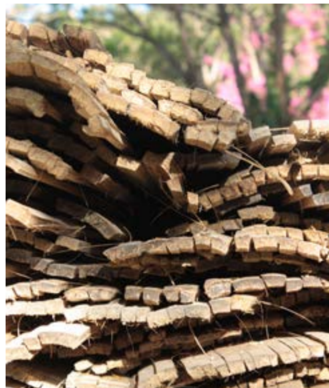
Fig.3 Lamelle di bambù per il semilavorato esterilla
