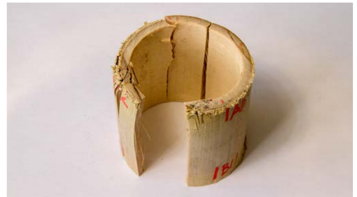
Fig.2 Un provino dopo la prova di compressione
