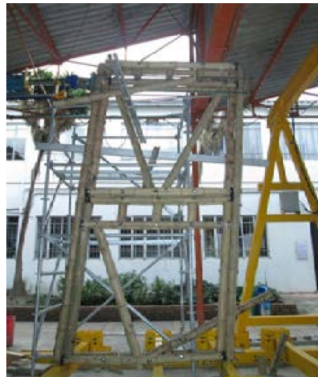
Fig.4 Prototipo tipo B sottoposto a carico orizzontale
