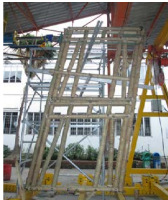
Fig.5 Prototipo tipo C sottoposto a carico orizzontale
