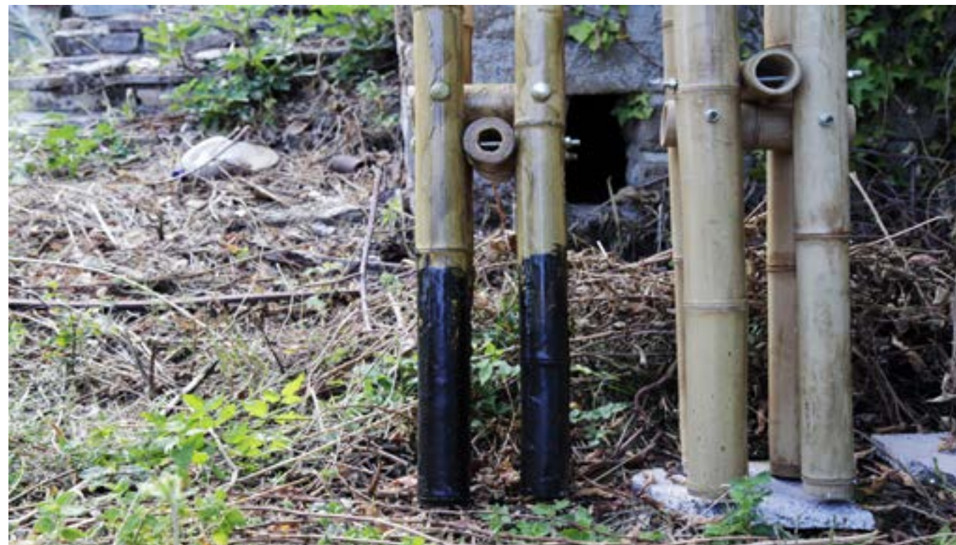
Fig.3 Culmi trattati con una resina naturale
