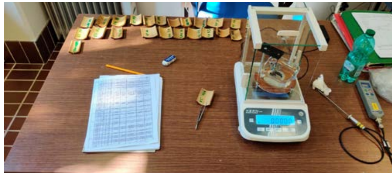
Fig.2 Tavolo di lavoro: i provini di bambù e la bilancia elettronica usata per stimare il loro peso
