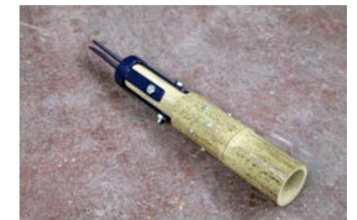
Fig.3 Prototipo di connessione realizzato con legno, viti autofilettanti e perni in acciaio adatto alle strutture reticolari piane e spaziali (M. Fabiani)
