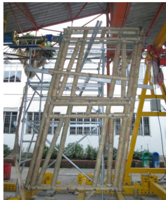
Fig.5 Prototipo tipo C sottoposto a carico orizzontale
