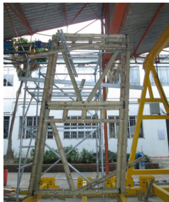
Fig.4 Prototipo tipo B sottoposto a carico orizzontale
