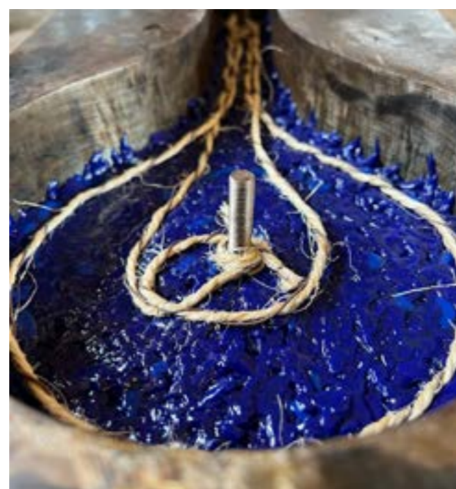
Fig.1 Elementi di plastica usati per la produzione del giunto Chameleon joint
